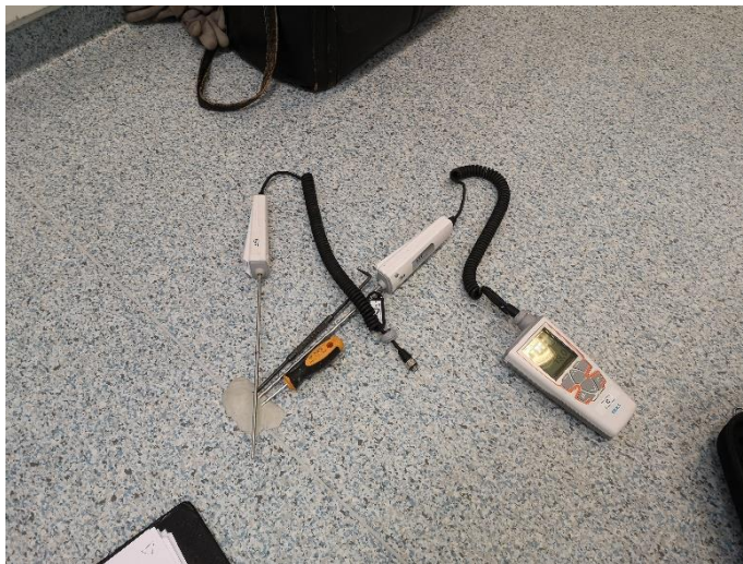
Kuva 4. Lattiarakenteen kosteusmittaukset tehtiin viiltomittausmenetelmällä.
