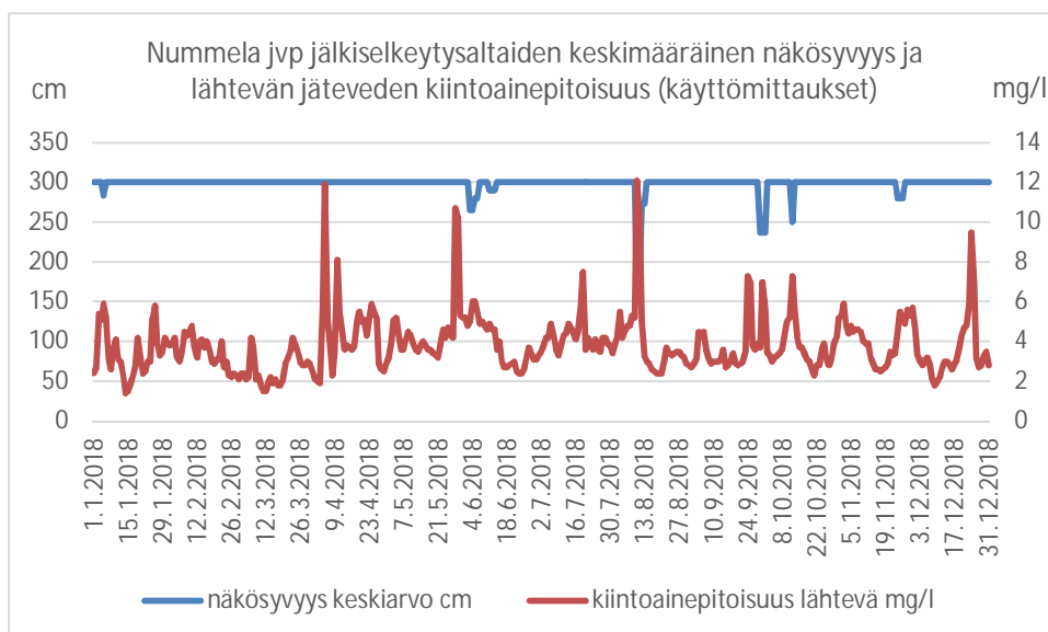
Kuva 6. Jälkiselkeytyksaltaiden 1-3 keskimääräinen näkösyvyys ja automaattisen kiintoainemittaukset tulokset (lähtevä vesi)
