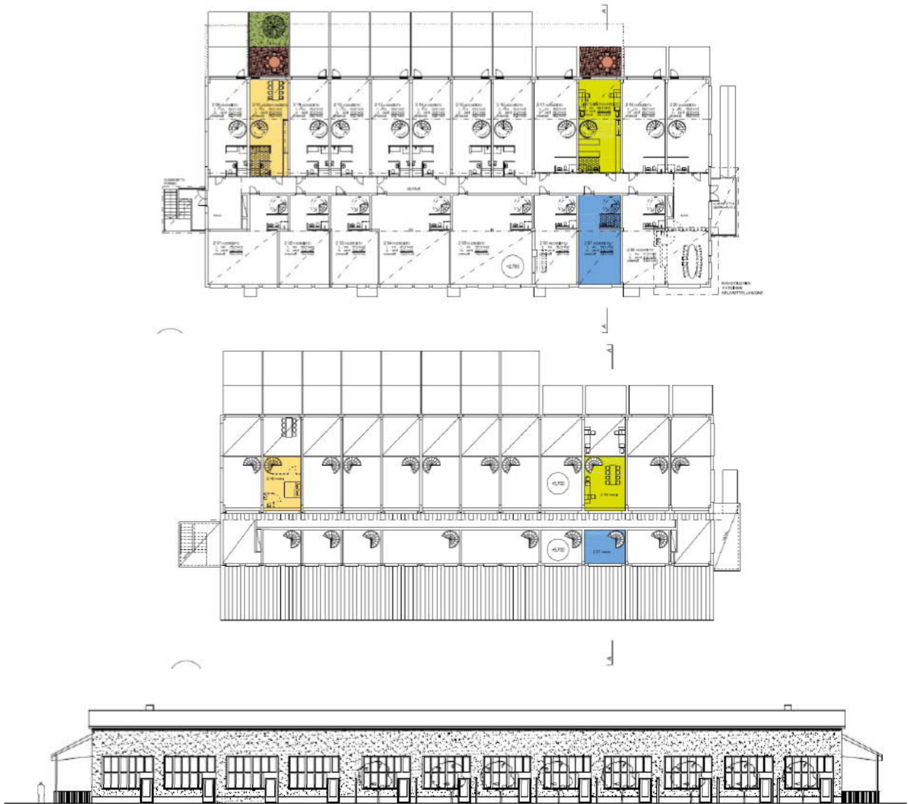
Arkkitehtitoimisto Minkkinen Oy:n alustavia suunnitelmia Rakves -rakennuksen käyttötarkoituksen muutoksesta. Yllä rakennuksen pohjapiirustukset 1. ja parvikerroksesta. Alla rakennuksen julkisivu länteen muutosten jälkeen.
