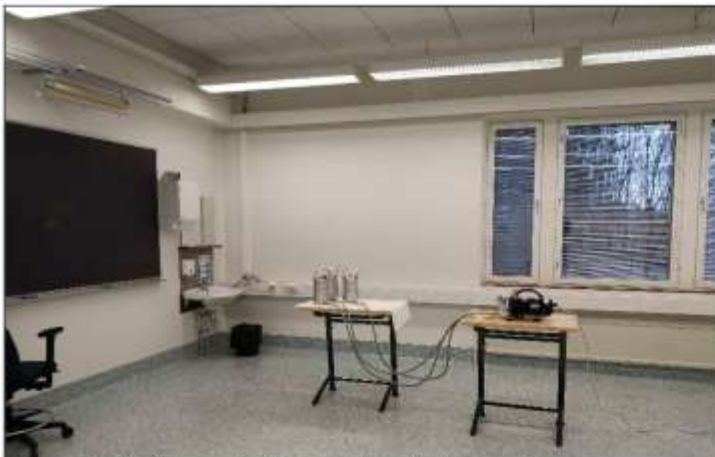
Kuva 8. Sisäilmanäytteet otettiin Andersen 6-vaihekeräimellä.
