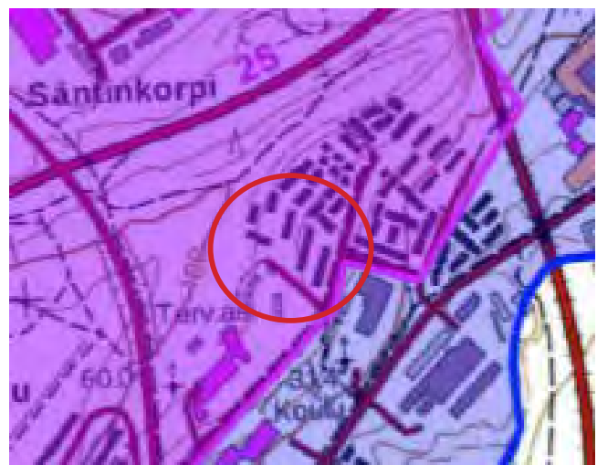
Pohjavesialue on esitetty kuvassa sinisellä (alue on päällekkäinen pohjavedenottaman suoja-alueen (pinkki) kanssa). Kaava-alue (rajattu punaisella soikiolla) sijoittuu kokonaan pohjavesialueelle ja pohjaveden suojelualueelle. Pohjaveden suojelualue (pinkki) sijoittuu Nummelanharjun lakialueelle.
