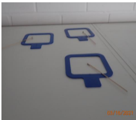
Kuvat 5 ja 6. Pintanäytteet on otettu 10 x 10 cm sabluunoilla. Keittiökalusteiden takapinnoilla on näkyvää pölyä.
