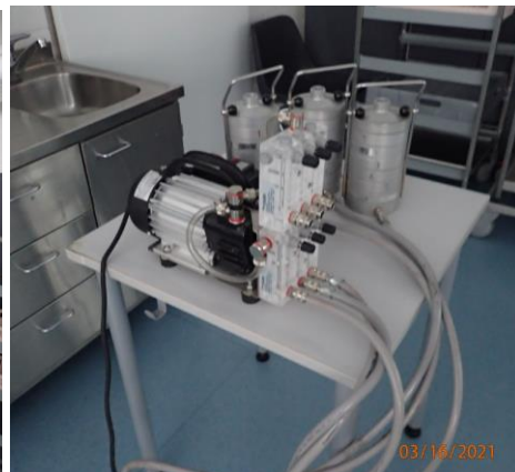
Kuvat 3 ja 4. Ruokalan näytepiste. Pyyhintänäyte kaapiston päältä. Ilmanäytteen laitejärjestely. Pumpun poistoilma pois päin keräimistä.
