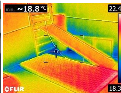
Kuvat 13 ja 14. Tilan 130 ulkoseinän nurkkaus on viileä alue, kun lähellä ei ole lämpölähdettä. Nurkkauksessa ei tulisi säilyttää patjoja ja muita huokoisien tavaroiden.
