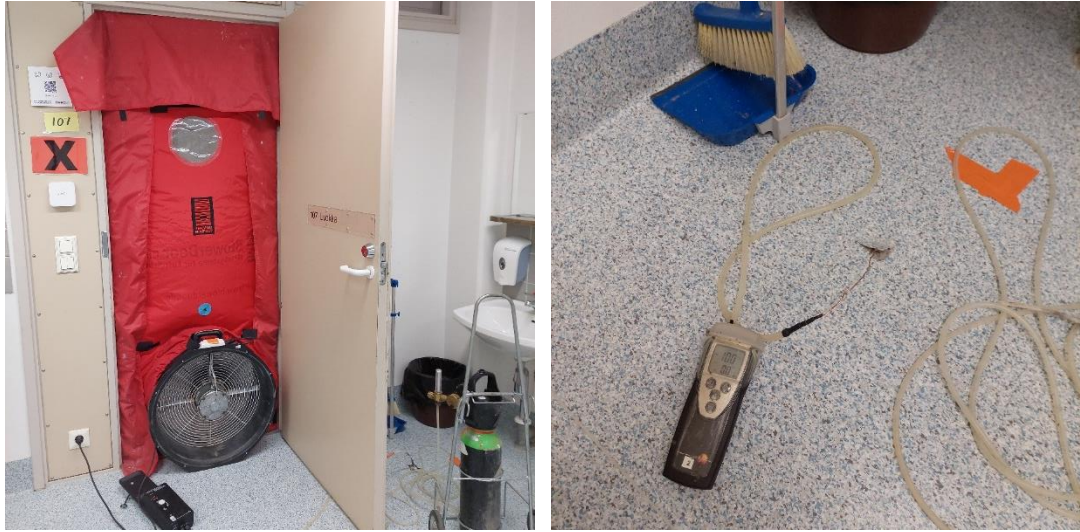
Kuvat 10 a ja b. Merkkiainekokeen mittausjärjestelyt. Mitattavat tilat alipaineistettiin Blowerdoor -kalustolla noin 10...11 Pa alipaineiseksi mitattavaan alapohjarakenteeseen nähden.
