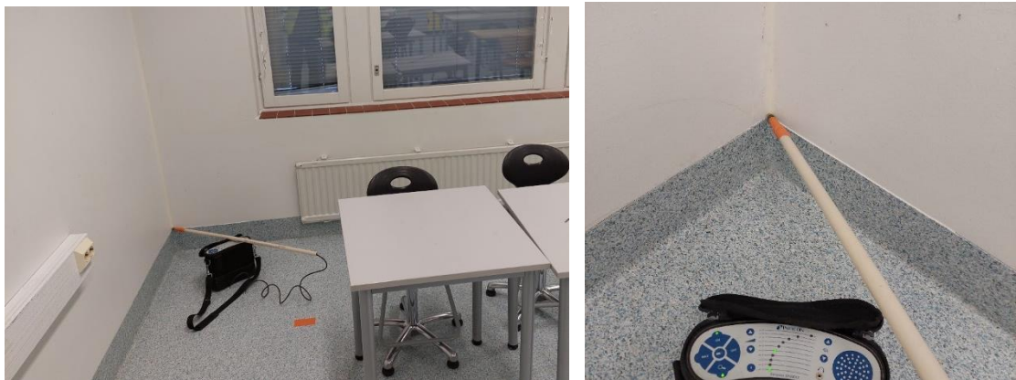
Kuvat 12 a ja b. Tila 122: heikkoa pistemäistä ilmavuotoa havaittiin lattia ja ulkoseinän liittymästä tilan nurkassa.
