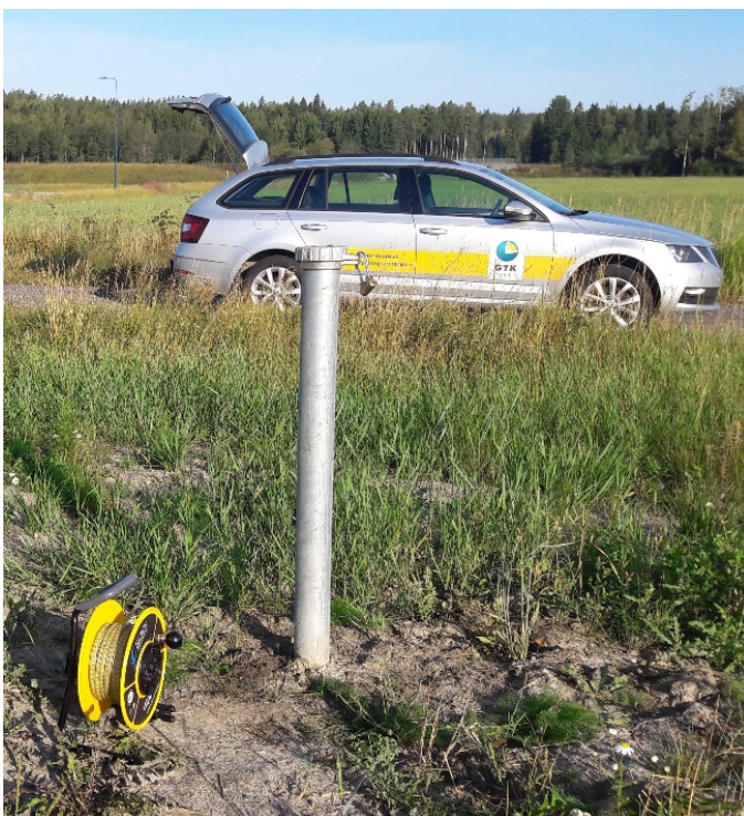
Kuva 5. Asennettu havaintoputki ja pohjaveden pinnan mittauksessa käytetty mittalaite. Kuva O. Sallasmaa, GTK.
