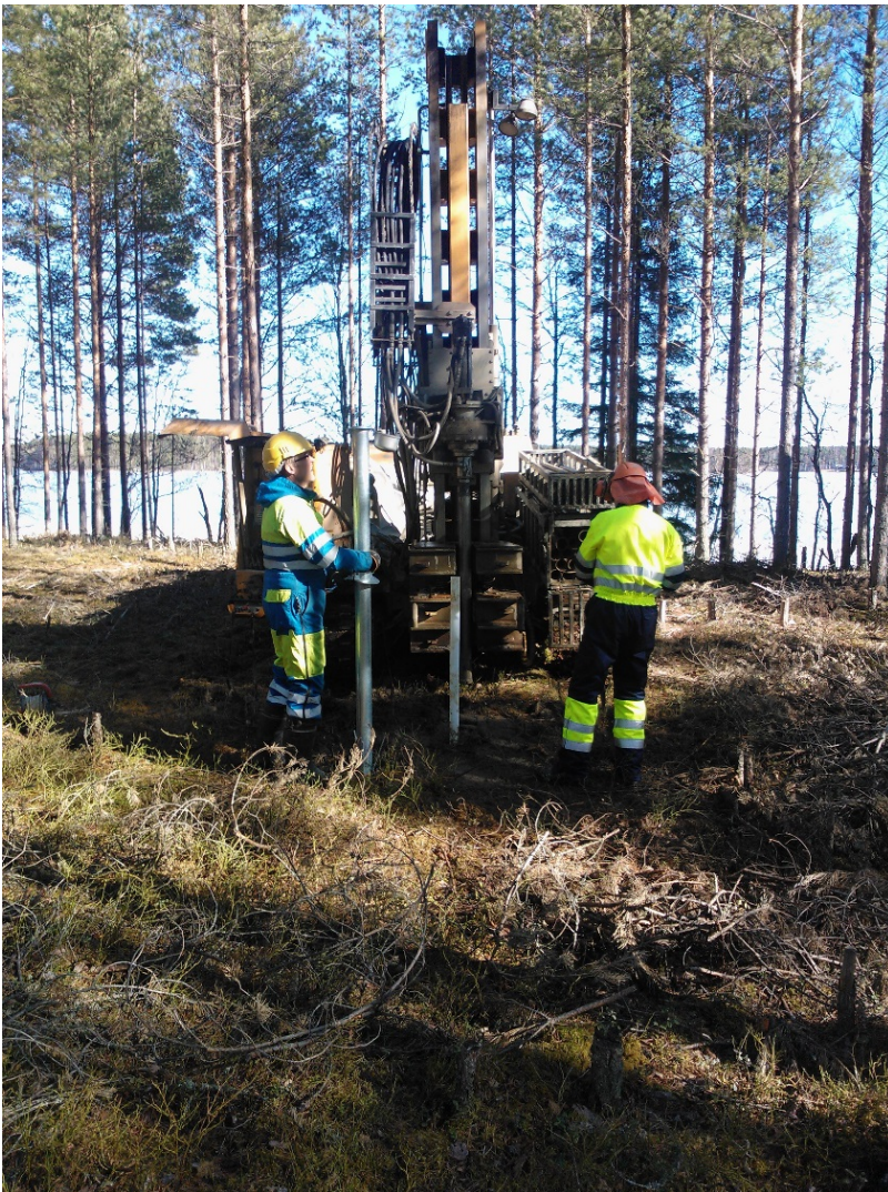
Kuva 4. Porakonekairaus ja havaintoputkiasennus. Kuva A. Eskelinen, GTK.
