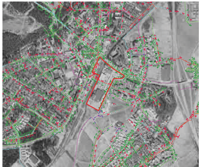
Kuvassa suunnittelualueen kunnallistekniikkaa. Kaukolämmön linjaukset on osoitettu kuvassa aniliinipunaisella viivalla.
