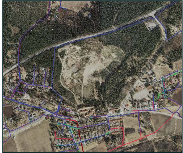
Kunnallistekniset verkostot suunnittelualueen lähistöllä. Vesijohtot on merkitty kuvaan sinisellä, sadevesiviemärit vihreällä ja jätevesiviemärit punaisella. Kaikki putkilinjat eivät näy kuvassa.
