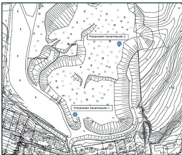
Pohjaveden havaintoputket 1-2 Auringonkehrän sorakuoppa-alueella.
