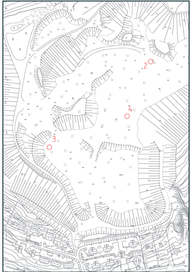
Pohjaveden havaintoputket 2-4 Auringonkehrän sorakuoppa-alueella.
